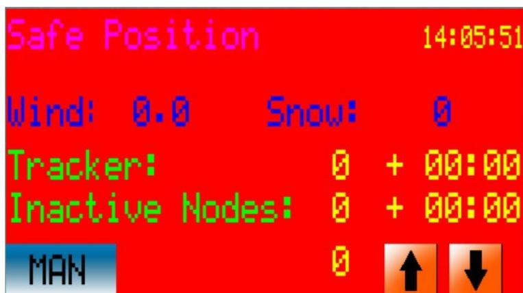
E' possibile, ad esempio, abbinare la prima posizione di sicurezza alla velocità del vento misurata da un anemometro, al superamento della soglia viene abbandonato il ciclo automatico e tutti i pannelli vengono posizionati nella relativa posizione di sicurezza.
