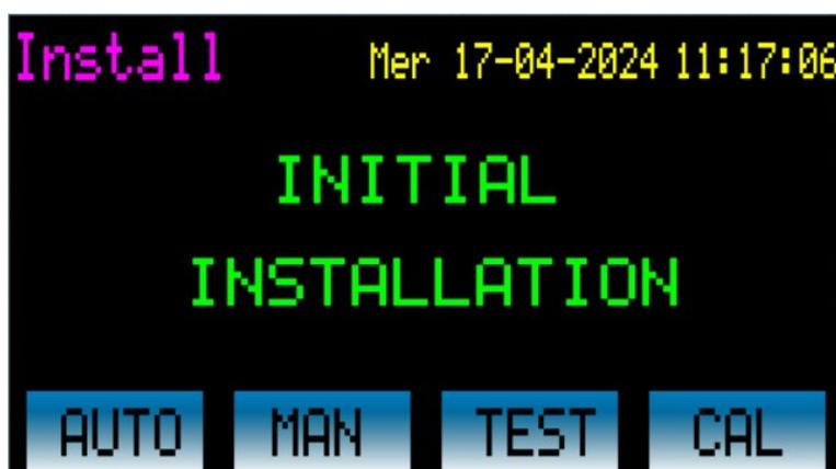
Una volta verificato il corretto funzionamento dell'impianto è possibile disabilitare questa funzione accedendo alla pagina di configurazione impianto e porre a zero il parametro `First Start`.
